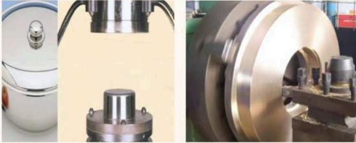
Paslanmaz tencerenin Korbak HB 15 ile derin sıvama işleminin üretimi
