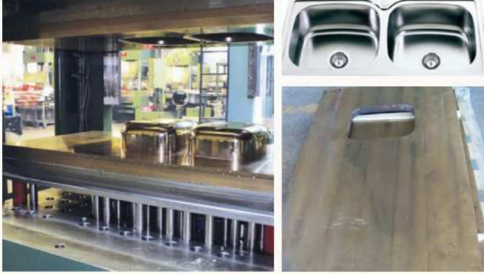
Paslanmaz mutfak evyesinin Korbak HB 15 ile derin sıvama işlemi
