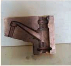
Döküm Kalıbı (kokil)
